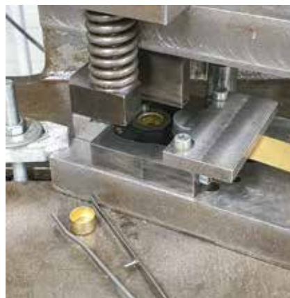
Összesen hat fázisban készülnek a BA7s és BA10s izzóaljzak. A képen a BA10s típus első fázisa, a mélyhúzás látható
