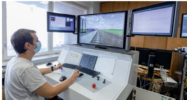
Siemens ETCS L2 tesztberendezés a MÁV Technológiai Központjában (TRI)
