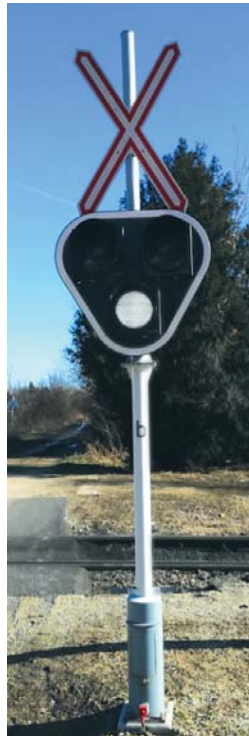
6. kép BUES 2000 útátjáró (AS99) SSB 200L fényforrással Gencsapátiban (2017. dec.-től)
