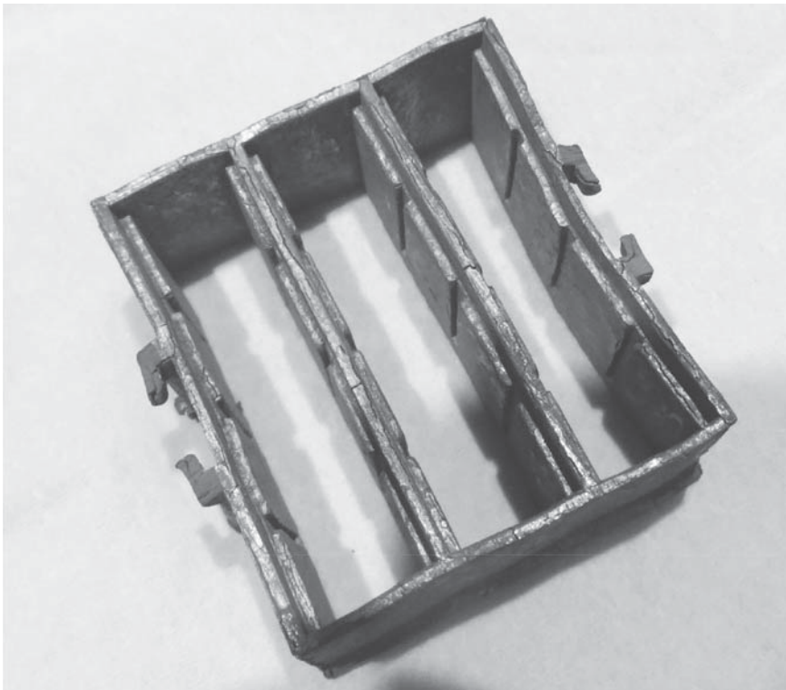
Deformálódott, rideggé vált fénycsatorna (spiáter, zamak öntvény)
